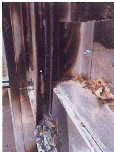
Bild 15 Detailaufnahme nach Versuchsende - Sturzkante
