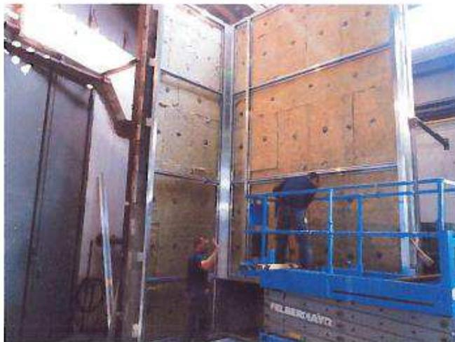
**Bild 1** Übersichtsaufnahme vor Versuchsbeginn - Fassadenaufbau
